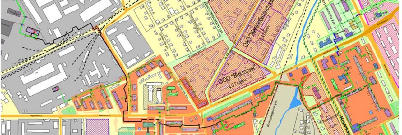
Рисунок 3...147 – Трассировка теплопровода от котельной ФГУП «Завод Электромаш» по ул. Федосеенко, д. 64 до конечного потребителя «ПТ-Остров,9»
