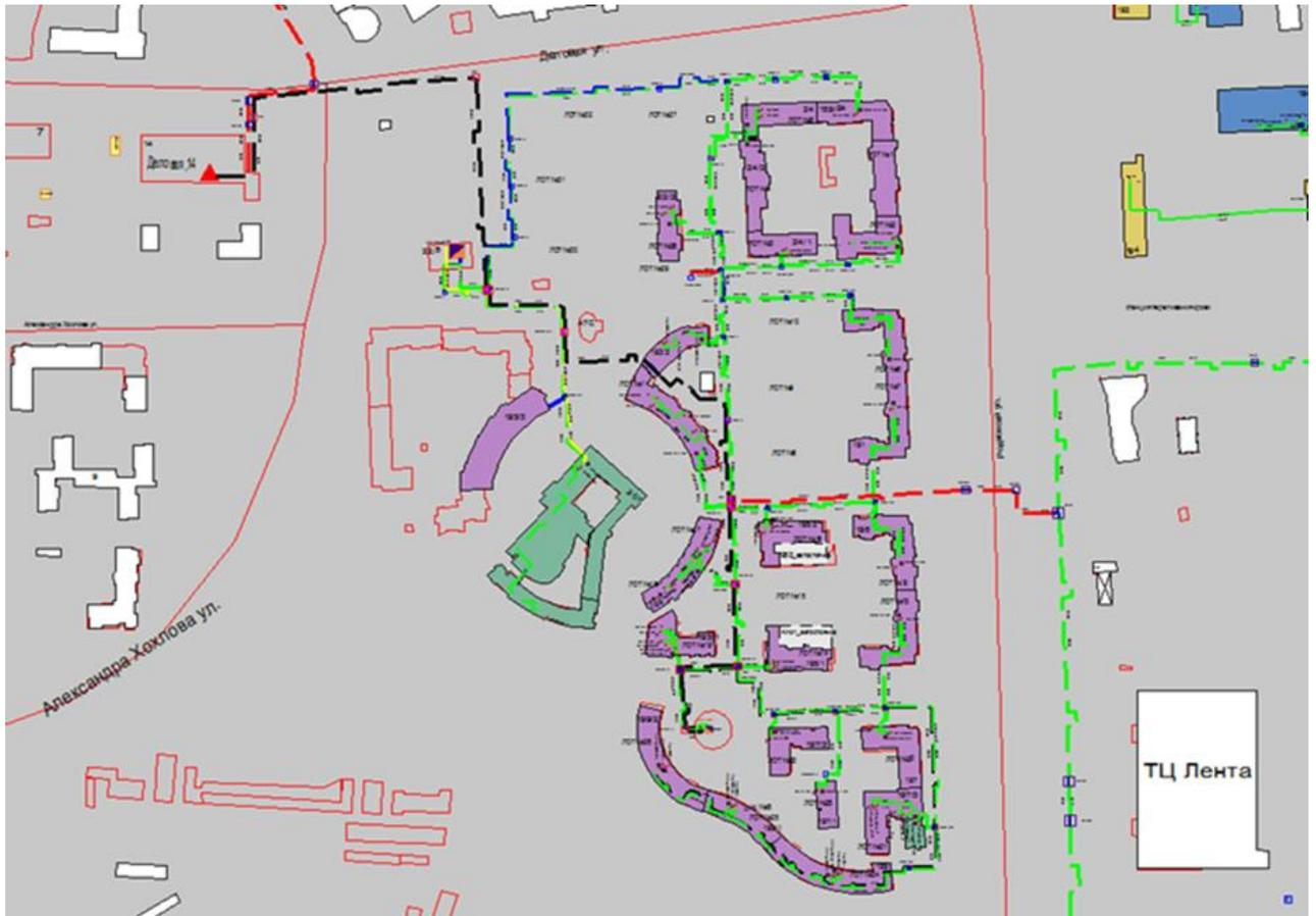
Рисунок 3.120 – Трассировка теплопровода от котельной ООО «Нижневтеплоэнерго» по ул. Деловая, д. 14 до конечного потребителя «ПТ-Рыбак,10/1»
